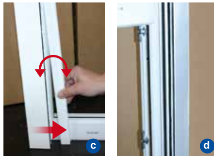
7. Universalschiene: Diese kann als Blendschiene (a) sowie auch als Insektenschutzlaufschiene (d) verwendet werden. Bei nachträglicher Montage wird die vorhandene Schiene herausgezogen (b), und gedreht wieder eingesetzt (c). Bei Verwendung als Insektenschutzlaufschiene wird die Laufschiene über eine Sicherungsschraube 15 cm von unten mit dem Grundprofil verbunden.
