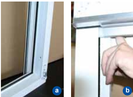
7. Universalschiene: Diese kann als Blendschiene (a) sowie auch als Insektenschutzlaufschiene (d) verwendet werden. Bei nachträglicher Montage wird die vorhandene Schiene herausgezogen (b), und gedreht wieder eingesetzt (c). Bei Verwendung als Insektenschutzlaufschiene wird die Laufschiene über eine Sicherungsschraube 15 cm von unten mit dem Grundprofil verbunden.
