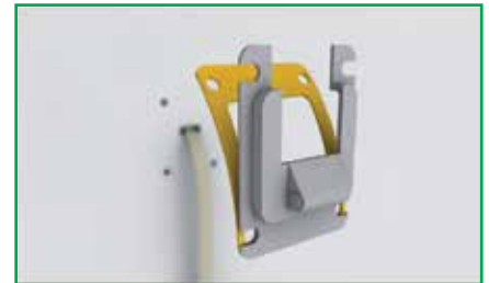
Schutzfolie des Zellkaut- schuk-Dichtrahmens entfernen und auf die Gurtführung aufkleben.
